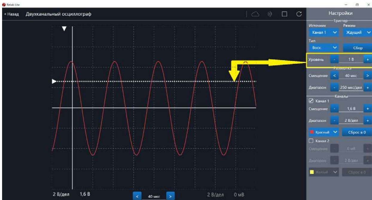
Рис. 37. Использование блока настройки Уровень
